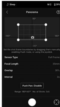
Panorama ermöglicht eine Reihe von miteinander verbundenen Standbildern mit präziser Steuerung aufzunehmen, basierend auf Sensortyp, Objektivbrennweite, Überlappung und Intervall.
